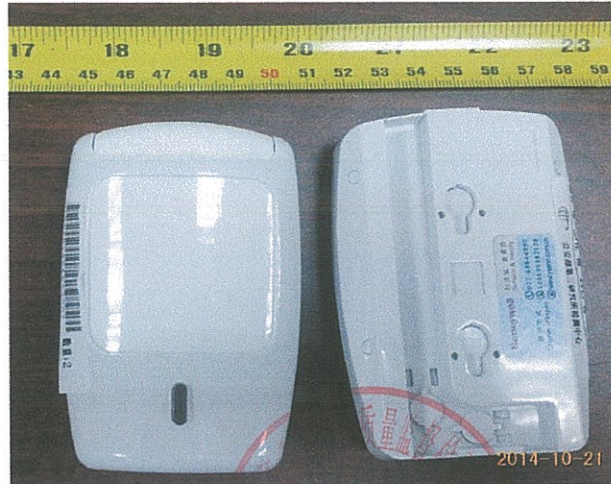
图一、IS-215T IS 系列室内用被动红外探测器外部结构
