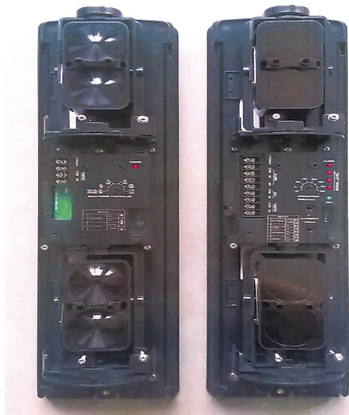
图二、HIBS-2110 型四光束主动红外入侵探测器内部结构
