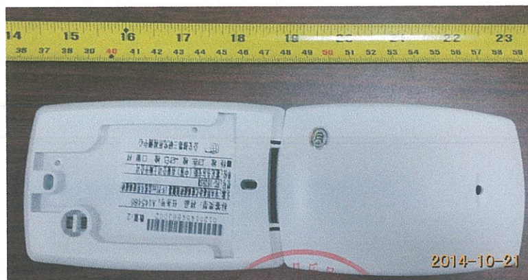
图一、FG-1625SN 室内用被动式玻璃破碎探测器 (V-Plex 总线专用玻璃破碎探测器) 外部结构
