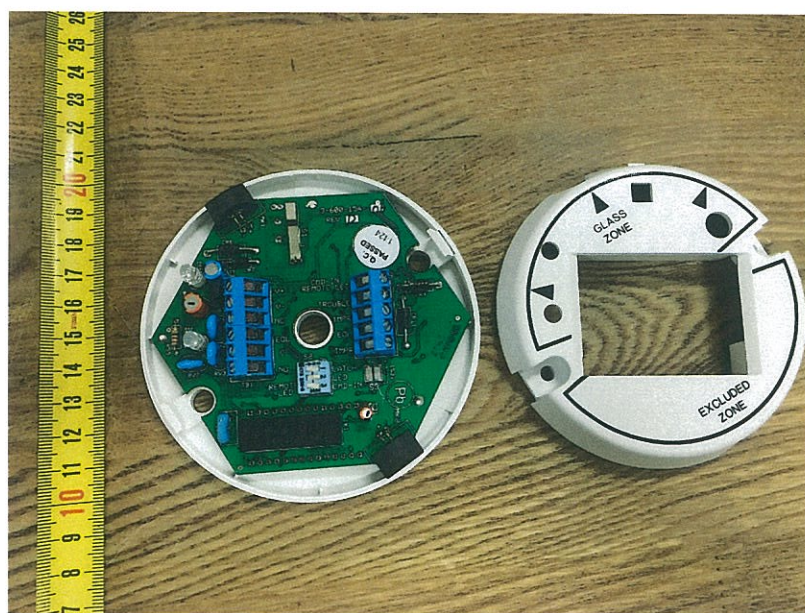
图二: FG-1025Z 型被动式玻璃破碎探测器 (FG 系列) 内部结构
