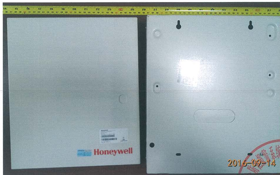
图一、2316 SUPER 防盗报警控制主机外部结构
