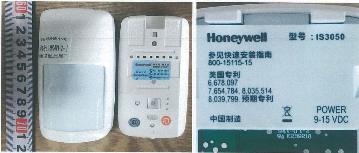
图一: IS3050 型室内用被动红外入侵探测器外观结构、标识
