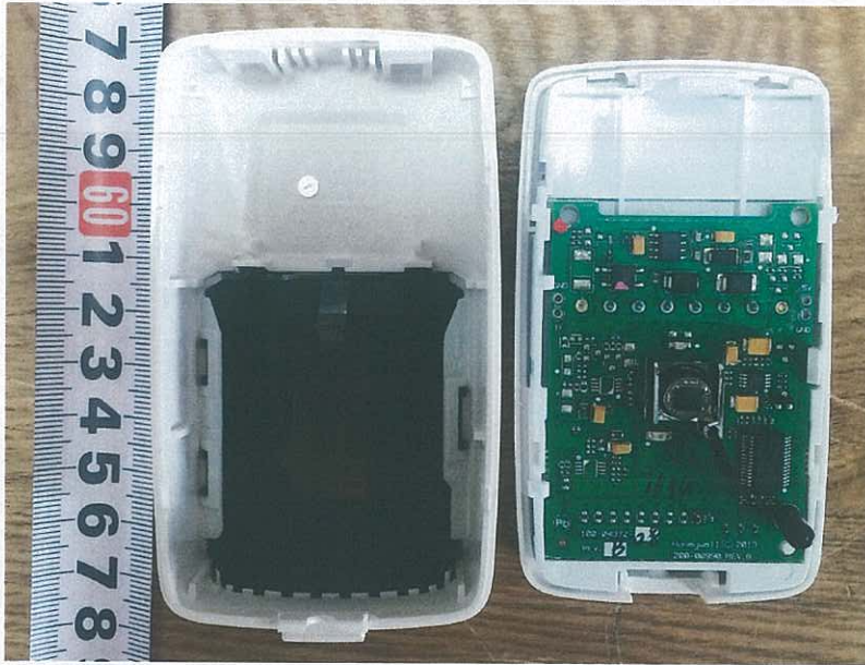
图三: IS3050 型室内用被动红外入侵探测器内部结构
