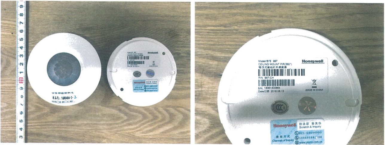
图一：997 型吸顶式被动红外探测器外观结构、标识
