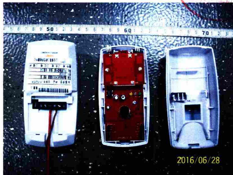
图二、LH-922BC 微波和被动红外复合探测器（智能三鉴）内部结构
