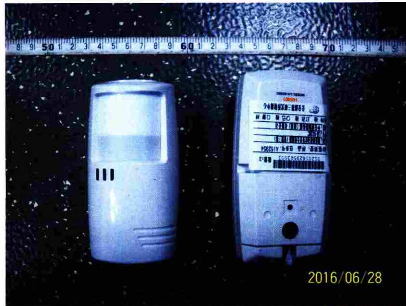
图一、LH-922BC 微波和被动红外复合探测器（智能三鉴）外部结构
