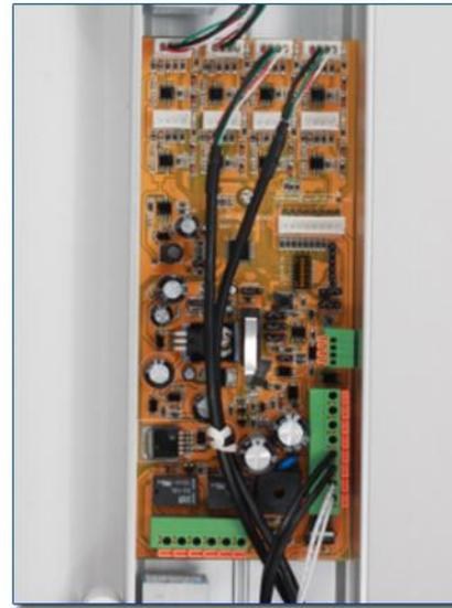
根据主机盒上面的接线方式进行接线
