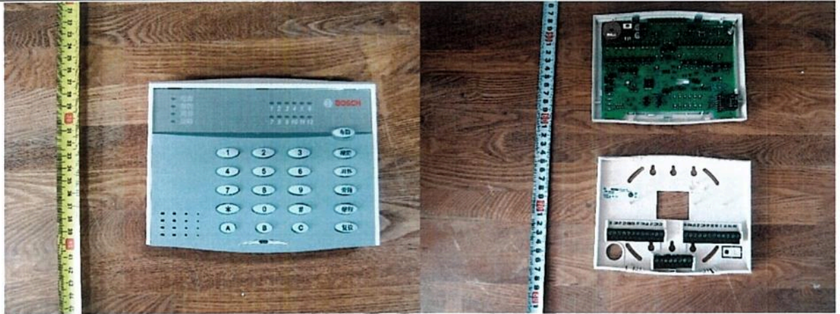
图一: IUI-DS12RG-CN 防盗报警控制器 (MT 系列防盗报警系统) 外部、主机内部结构
