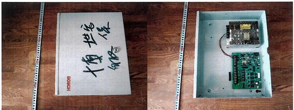
图三: IUI-DS12RG-CN 防盗报警控制器 (MT 系列防盗报警系统) 电源箱外观及内部结构
