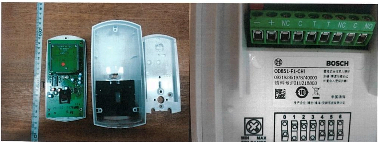
图二: OD851-F1-CHI 型壁挂式三技术入侵探测器 (微波与被动红外复合入侵探测器) 内部结构、标识
