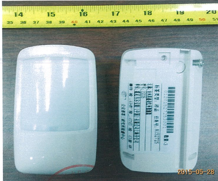
图一、IS335 室内用被动红外入侵探测器外部结构
