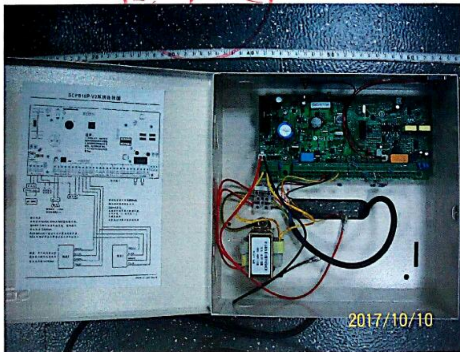
图二、SCP816P-V2 防盗报警控制器内部结构
