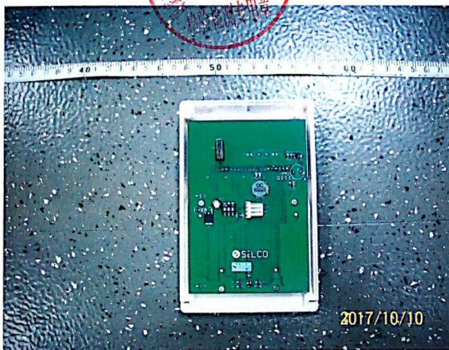
图四、键盘内部结构
