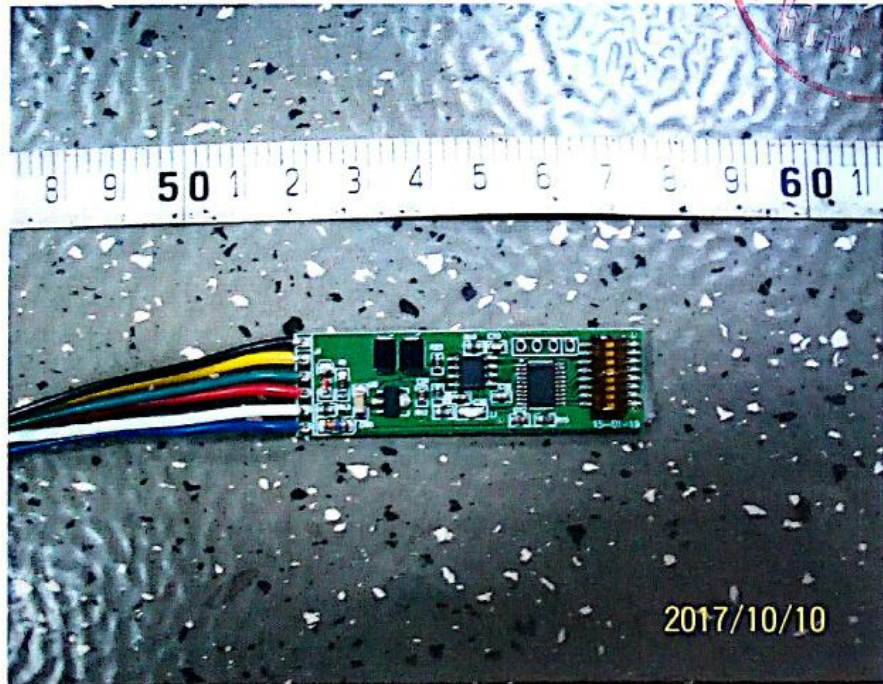
图六、STP-2401 单防区扩展模块内部结构
