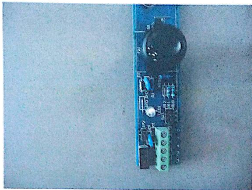
图三: SBW-06S60 型主动红外入侵探测器 (红外线隐形防盗幕栏) 投光器接口和显示灯
