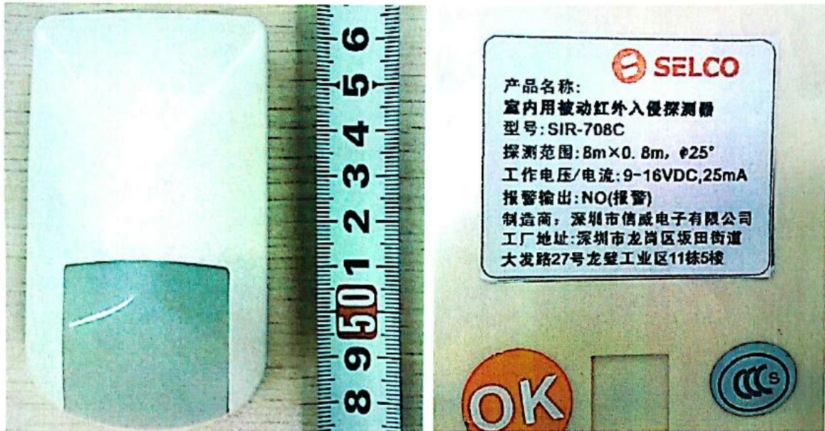
图一: SIR-708C 型室内用被动红外入侵探测器外观结构、标识
