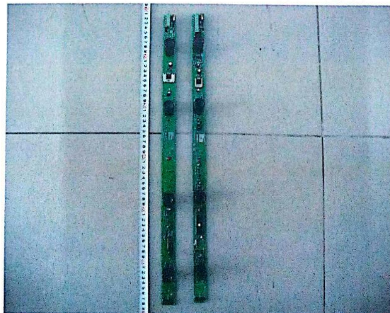
图二：SBW-04S100 型主动红外入侵探测器（红外线隐形防盗幕栏）内部结构
