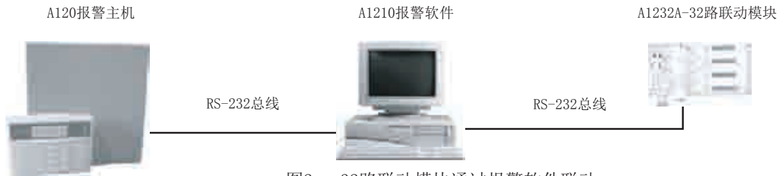
图2：32路联动模块通过报警软件联动
